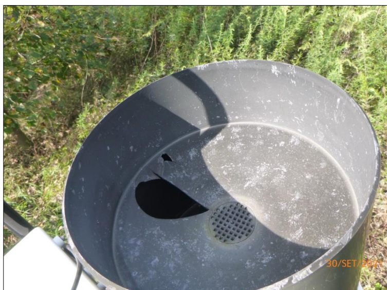
Foto 1: dettaglio rottura pluviometro
